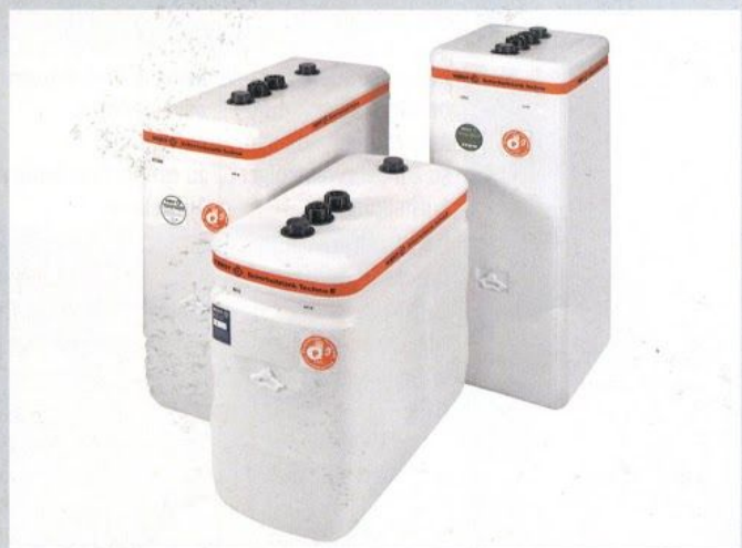
Bei modernen Heizöltanks umschließt ein Außentank wie eine zweite Hülle den eigentlichen Öltank. Somit wird ein mögliches Auslaufen des Heizöls verhindert und der bisherige Auffangraum im Keller überflüssig.
